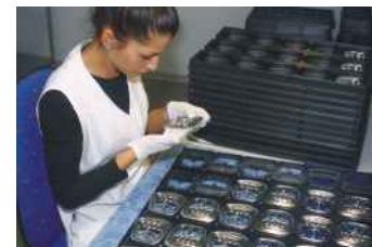
Oben: 100 Prozent Sichtprüfung. Eine Silcos-Mitarbeiterin nimmt die mit wenigen Atomlagen Metall beschichteten Kunststoff-Teile unter die Lupe, die als Zierring und Audi-Emblem (unten) am Lenkrad verbaut werden.
